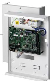
■ **Bloc d'alimentation SPCP332.300 (7 Ah) avec transpondeur 8 entrées/2 sorties**
